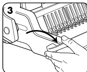
3. Trekk binderåpningsspaken fremover for å åpne binderen.
