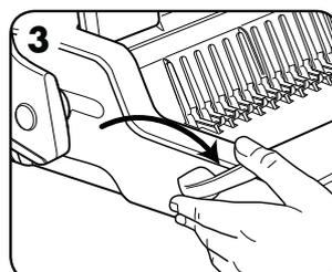
3. Dra i öppningsspak för plastrygg för att öppna.
