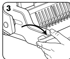
3. Потяните вперед рычаг раскрытия гребенки, чтобы раскрыть ее.
