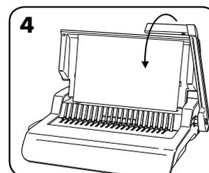
4. Testați perforatorul cu coli de rebuturi pentru a verifica setarea ghidajului de margine.
