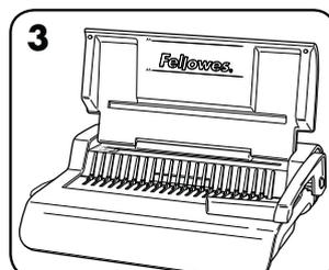
3. Lyft locket. Se till att öppningsspak för plastrygg skjuts tillbaka.
