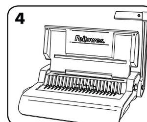
4. Podignite ručku za bušenje do uspravnog položaja.
