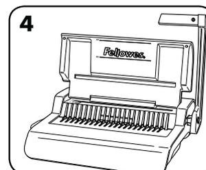
4. Zvedněte děrovací páku do vzpřímené polohy.
