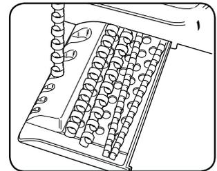
1. اختر كعب بلاستيكي بقطر مناسب بالاستعانة بدرج الاحتفاظ بالكعوب البلاستيكية.
