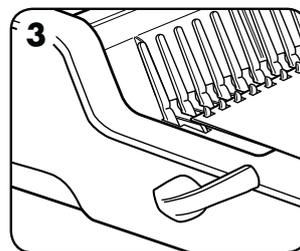
3. Děrované listy zavádějte přímo na rozevřený hřeben. Začněte přední částí dokumentu.
