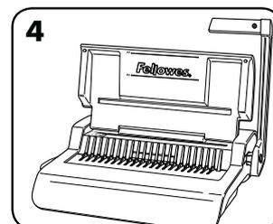
4. Levante el asa de perforación hasta colocarla en posición vertical.
