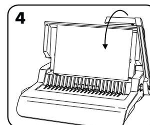
4. Procéder à un test de perforation de feuilles de brouillon pour vérifier le réglage de la butée de taquage.
