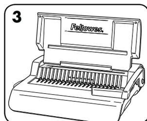
3. Levante la tapa. Asegúrese de que la palanca de apertura de canutillo está presionada hacia atrás.
