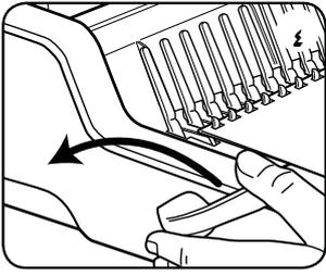
4. بعد وضع جميع الأوراق المثقوبة داخل الكعب البلاستيكي، ادفع ذراع خريك حلقات الكعب للخلف لإغلاق حلقات الكعب. ثم أزل المستند الذي تم تجميعه من الماكينة.
