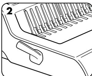
2. Introduceți pieptenele de plastic în mecanism.
