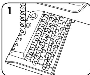
1. Выберите гребенку соответствующего диаметра, используя лоток для хранения гребенок.
