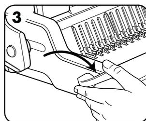
3. Tire de la palanca de apertura de canutillo hacia adelante para abrir el canutillo.
