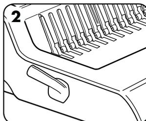
**2** Den Plastikamm in den Mechanismus einsetzen.
