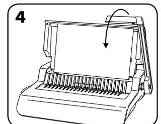
**4** Restblätter teststanzen, um die Einstellung der Seitenführung zu prüfen.
