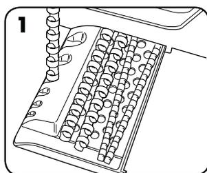
1. Seleccione el diámetro del canutillo correcto utilizando la bandeja de almacenamiento de canutillos.
