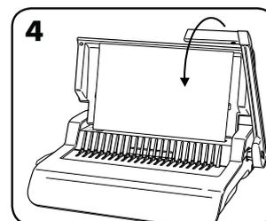
4. Az élvezető beállításának ellenőrzésére, kidobásra szánt lapokon végezzen tesztlyukasztást.
