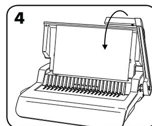
4. Perfore algunas hojas de prueba para comprobar la posición de la guía lateral.
