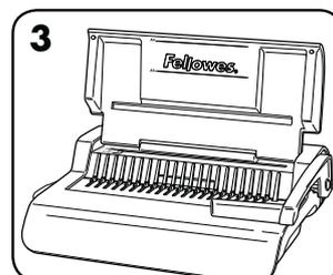
3. Поднимите крышку. Убедитесь, что рычаг для раскрытия гребенки отведен назад.
